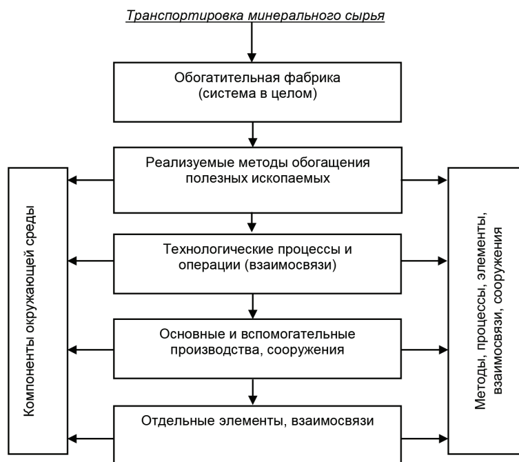
Рис. 2. Блок-схема влияния методов, процессов, элементов, взаимосвязей, сооружений на компоненты окружающей среды при переработке золото-содержащего минерального сырья (направление оценки от общего к частному) / Fig. 2. Flowchart of the influence of methods, processes, elements, interconnections, structures on environmental components during the processing of gold-containing mineral raw materials (direction of assessment from general to particular)
